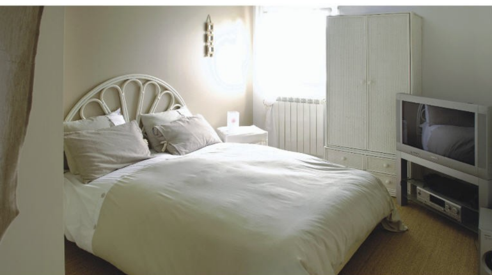
Les pièces de l'étage sont chauffées par des radiateurs en fonte d'aluminium. Une seule chaudière alimente les deux maisons, mais avec deux circuits séparés. Le parquet flottant de cette chambre est en wengé.
